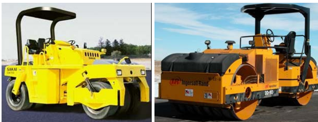
غلتک چرخ آهنی صاف ارتعاشی (سمت راست) و غلتک چرخ لاستیکی ارتعاشی (سمت چپ)
