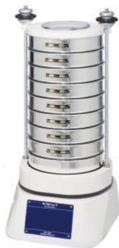
شکل ۱۰: انواع الک و دستگاه لرزاننده (Shaker)
