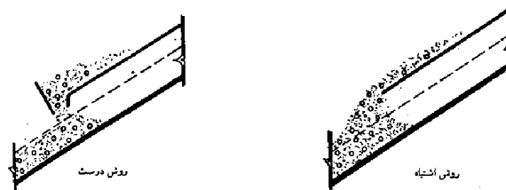
شکل ۳۶: بتن ریزی در سطوح شیب‌دار
