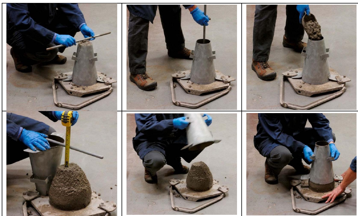
شکل ۱۸: مراحل انجام آزمایش اسلامپ
