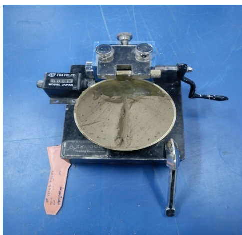
۳-۴-د) بعد از به هم رسیدن نمونه بخشی از آن برای تعیین درصد رطوبت جدا شود.
