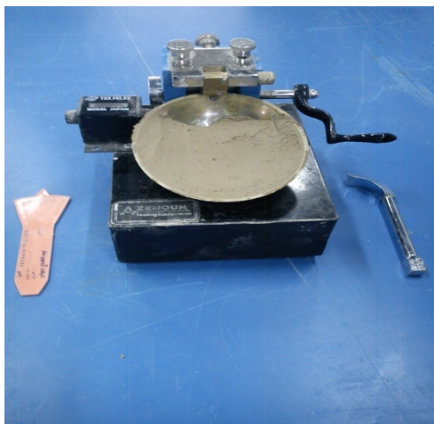
۳-۴-ب) خاک با دقت و به طور یکنواخت، به میزان لازم در جام قرار گیرد.
