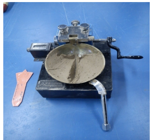
۳-۴-ج) با سرعت ۱۲۰RPM به جام ضربه وارد تا دو طرف شیار به اندازه ۱۲/۷mm به هم برسد.
