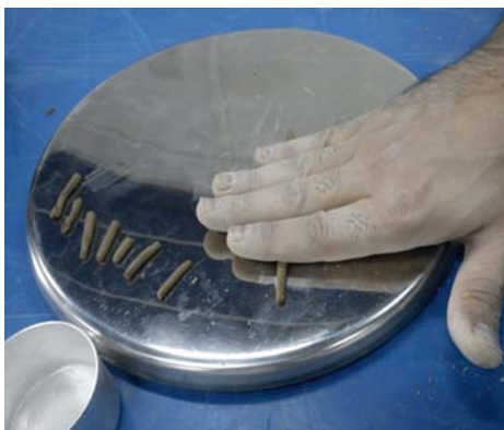
شکل (۳-۵): روش انجام آزمایش تعیین حد خمیری غلتاندن نمونه ها و جدا کردن نمونه ها
