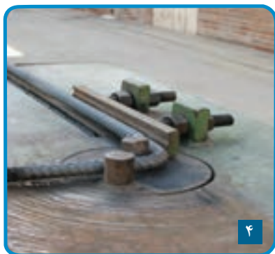
شکل ۶۴-۳- خم کردن میلگرد
