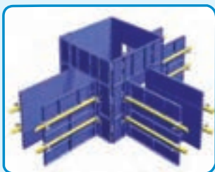
شکل ۳-۲۸- قالب فلزی برای اجرای پی
