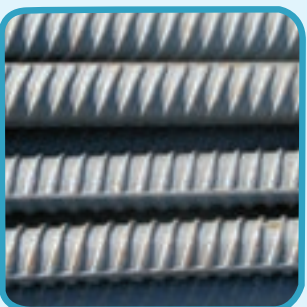
شکل ۱۷-۱- میلگرد با رویه آجدار
